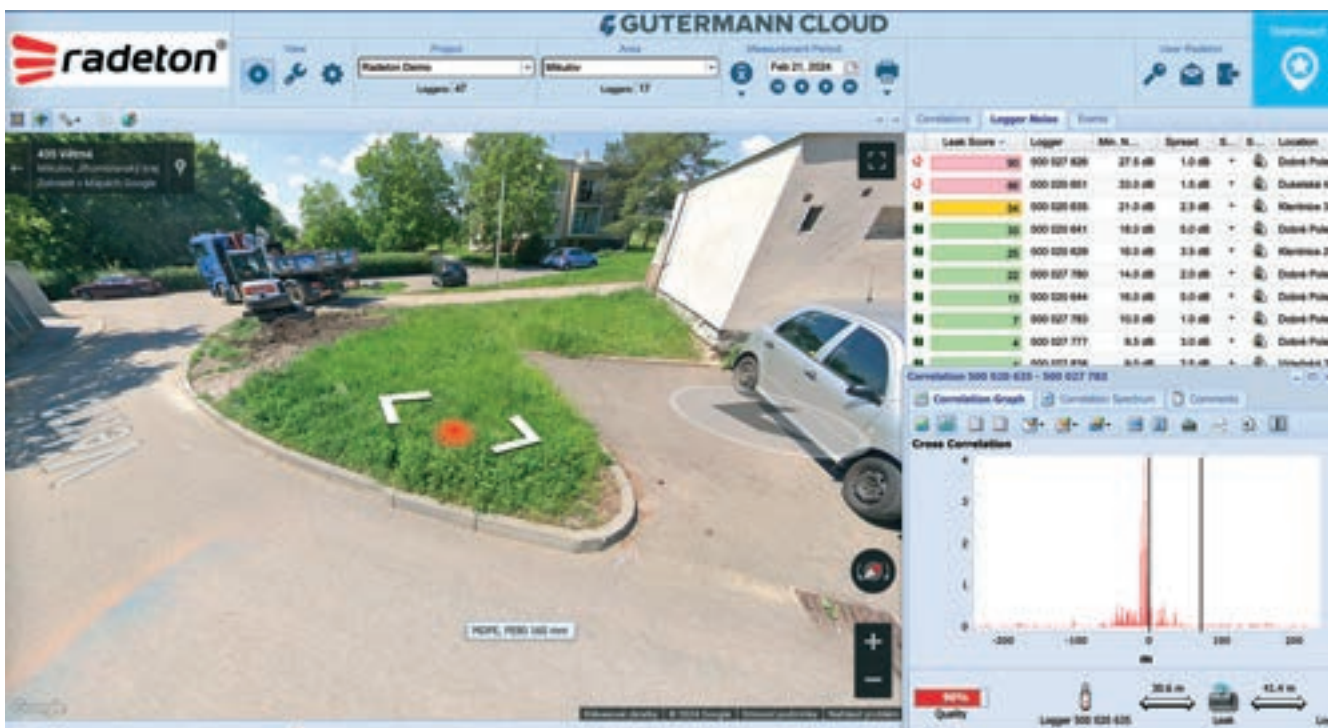
Obr. 4: Lokalizace úniku v Mikulově na MDPE DN 160 na vzdálenost 72 m a zobrazení místa úniku v Google Street View
