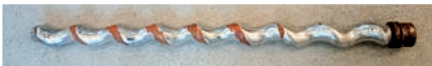
Obr. 2: Opatřovaný rotor podávacího čerpadla Seepex po zhruba dvou letech provozu
