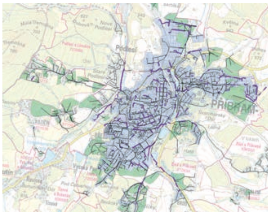
Obr. 5: Příklad vyhodnocení hydraulických poměrů na stokové síti města Příbram ve stávajícím stavu
