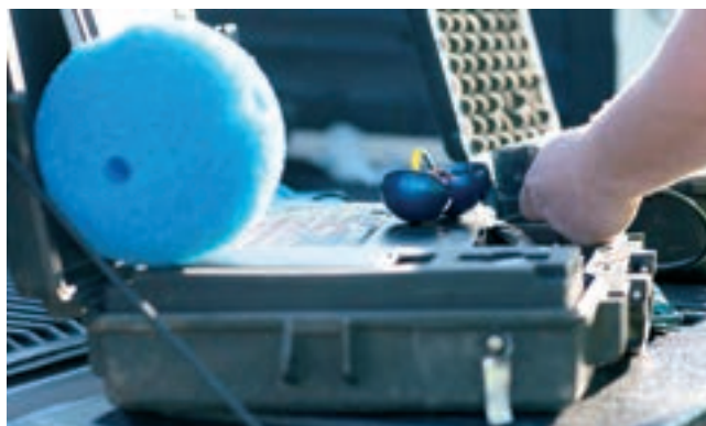
Obr. 4: Synchronizace Smartball jádra se sledovací jednotkou
