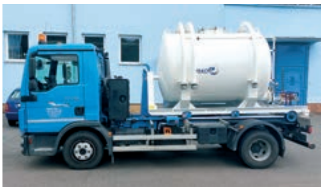
Obr. 3: Pojízdna cisterna, přizpůsobená pro doplňování vápence
