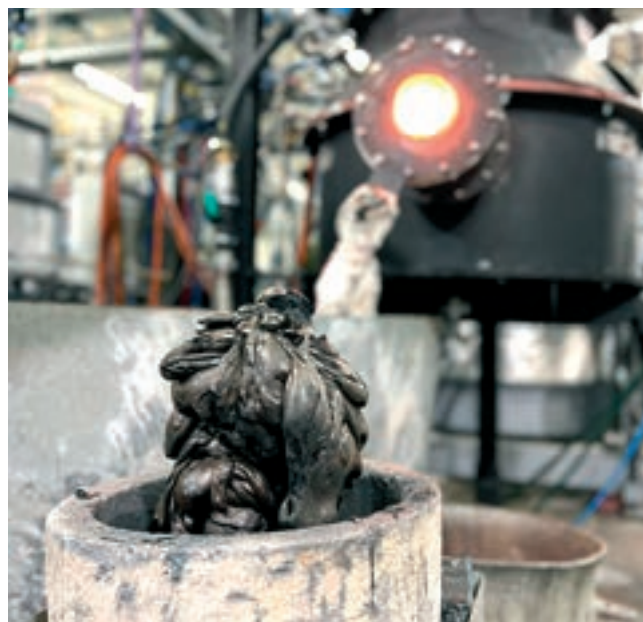
Takto vypadá inertní struska po vypuštění z reaktoru a vychladnutí.
