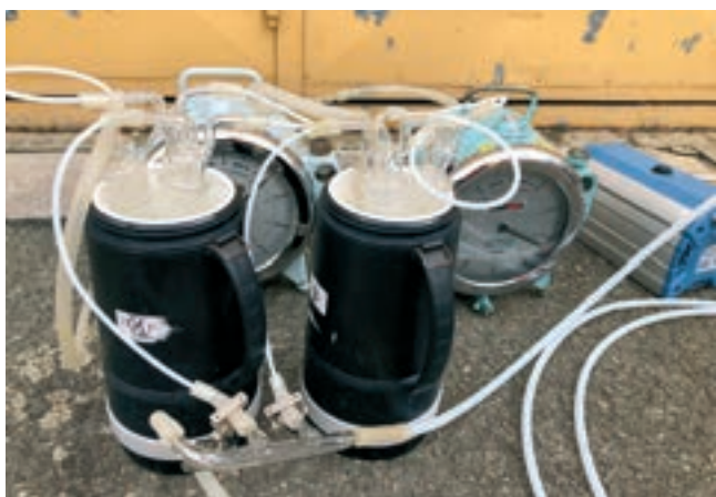
Obr. 3: Odběr vzorků v praxi – měření siloxanů v bioplynu, sorpce siloxanů do toluenu v promývačkách
