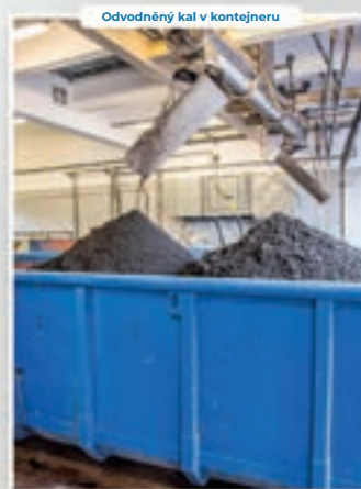
Odvodněný kal z ČOV Mělník odvážíme k dalšímu zpracování.
