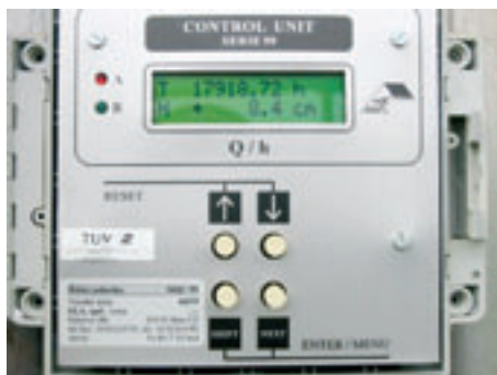
Obr. 11: Ukázky vyhodnocovacích jednotek užívaných v případech metody Q/h charakteristiky
