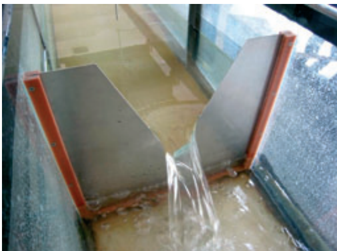
Obr. 4: Ostrohranný přeliv s výřezem tvaru V s vrcholovým úhlem 58° při kalibraci v měrné trati laboratoře
