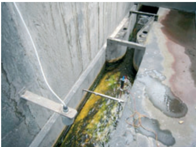
Obr. 6: Popravní pohled na Venturiho žlab s šířkou hrdla 150 mm, v popředí ultrazvukový snímač pro měření hloubky proudu před žlabem
