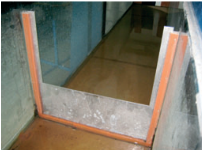
Obr. 3: Ostrohranný přeliv s pravoúhlým výřezem s bočním zúžením
