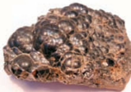
Obr. 1: Ledvinový agregát uraninitu, Škrdlovice, ČR. Velikost vzorku 7,5 x 5,5 cm. Sbírky Geologického pavilonu VŠB-TU Ostrava, foto J. Jirásek 2004.
