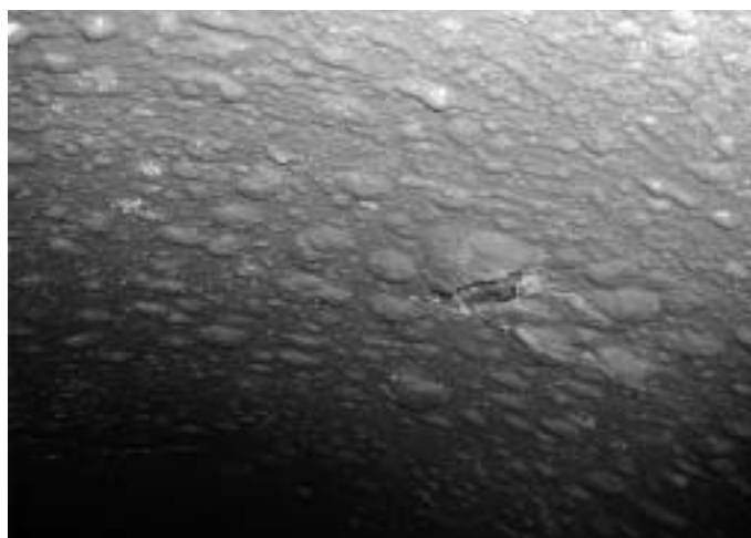
Obr. 5: Úsek s výskytem velkých, ojediněle popraskaných a odpadlých puchýřů
