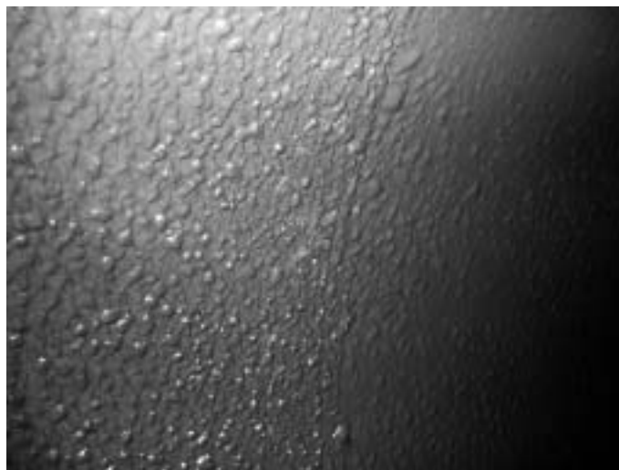
Obr. 4: Drobná puchýřovitost charakteristická pro většinu kontrolovaných úseků
