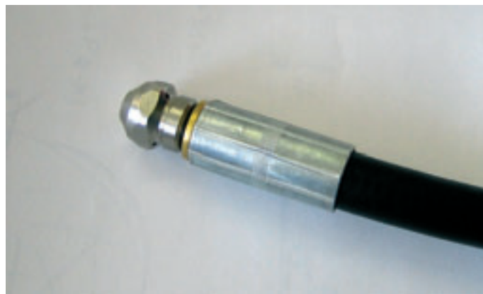
Obr. 8: Detail trysky pro rozmrazování potrubí
