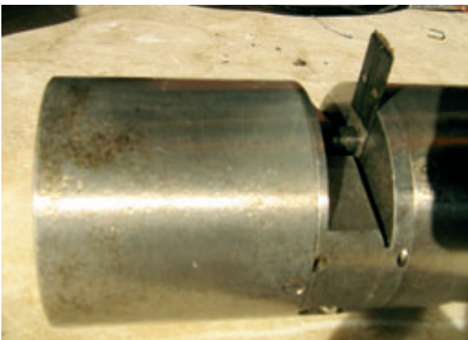
Obr. 6. a 7: Detail automatického stíracího zařízení na čištění sond
