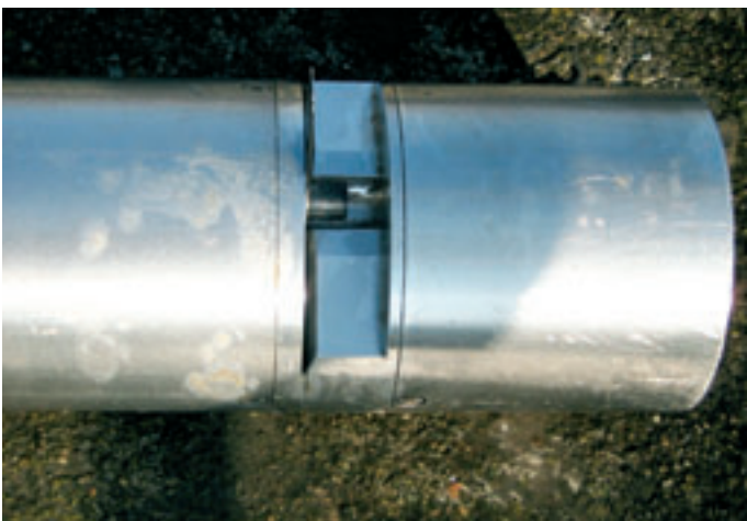
Obr. 5: Detail měřicí štěrbině 1 mm
