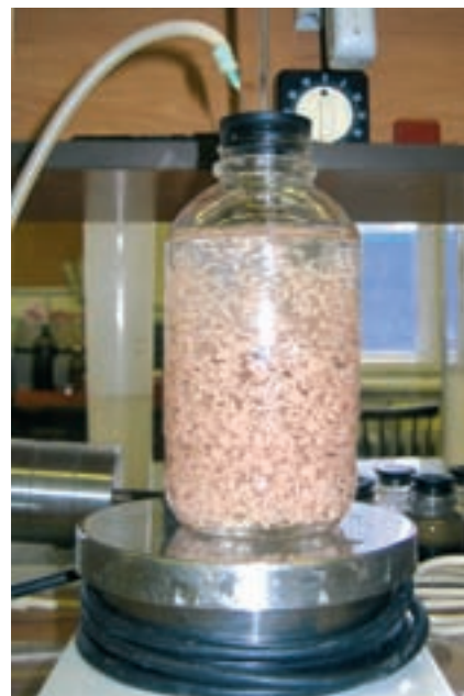
Obr. 2: Uspořádání denitrifikačního testu s biokatalyzátorem lentikats
