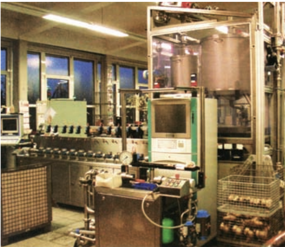
Obr. 1: Moderní zkušební stolice pro domovní vodoměry ve státem uznané zkušebně
