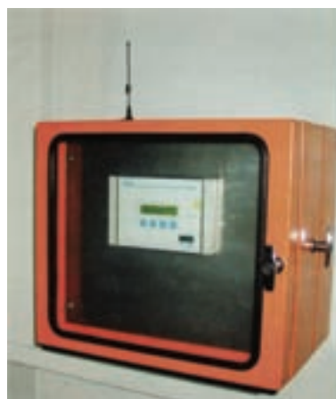
Obr. 3: Zásobník dat na koncovém profilu v krabici-obalu-krytu s nepřerušovanou dodávkou el. proudu a modemem GSM
