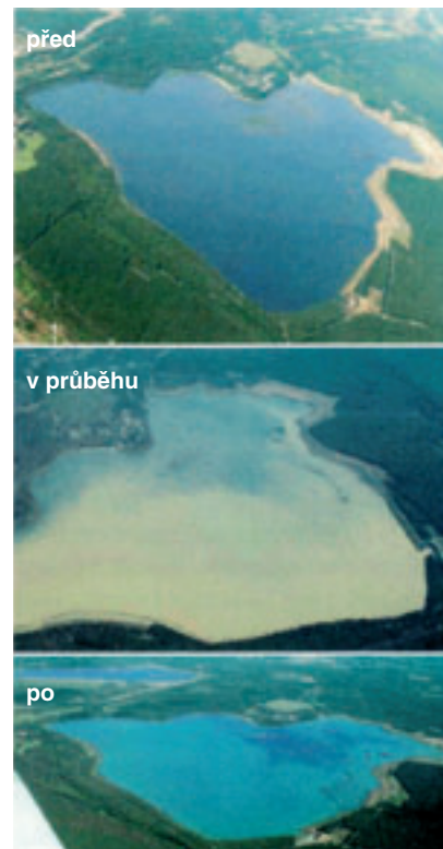
Obr. 1 (vlevo): Uvedení vápenného kalu bývalého GWRA 2004 zpět do vznosu v jezeře v jámě po vytěžení uhlí Koschen pomocí asi 1 000 m dlouhého rozdělovacího trubního systému. Obr. 2 (vpravo): Letecké snímky jezera v zaplaveném vytěženém uhelném dole Burghammer před, v průběhu a po aplikaci technologie alkalizace v jezeře
