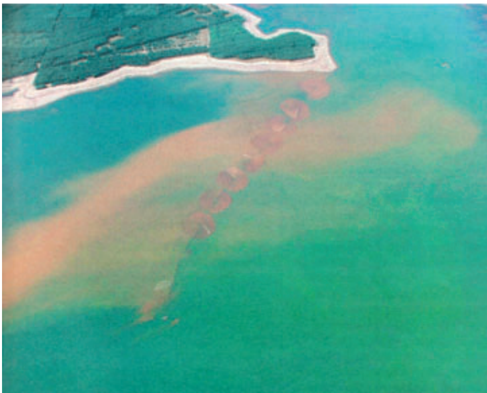
Obr. 1 (vlevo): Uvedení vápenného kalu bývalého GWRA 2004 zpět do vznosu v jezeře v jámě po vytěžení uhlí Koschen pomocí asi 1 000 m dlouhého rozdělovacího trubního systému. Obr. 2 (vpravo): Letecké snímky jezera v zaplaveném vytěženém uhelném dole Burghammer před, v průběhu a po aplikaci technologie alkalizace v jezeře
