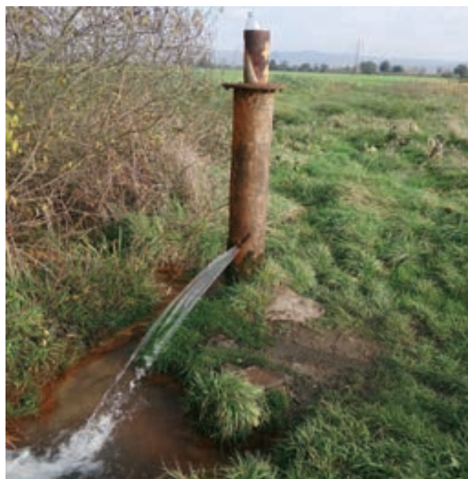
Obr. 3: Havarované vrtly – vodárenský vrt s přetokem 100 l/s a tlakem na zhlaví 800 kPa (nahore) a nefunkční monitorovací vrt určený ke sledování stavu hladiny podzemní vody (vpravo)
