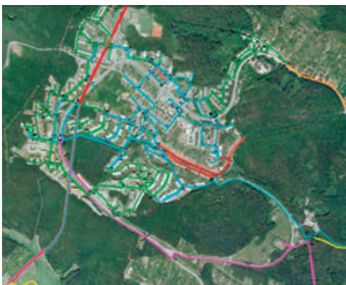
Obr. 1: Vodovodní síť tlakového pásma 1.3.2 Kohoutovice
