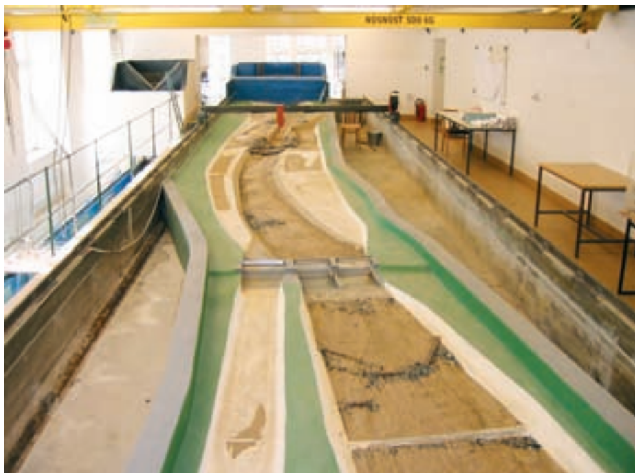
Obr. 2: Protiproudění pohled na model koryta vodního toku ve žlabu šířky 3,5 m, vlevo nátok do žlabu šířky 1,0 m
