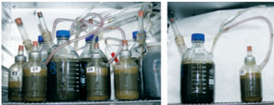
Obr. 2: Reaktory použité v experimentech (v testu I i II). Vlevo jsou reaktory umístěné v termoboxu, vpravo pak detail jedné dvojice hydrolyzního (vpravo) a metanizačního reaktoru (vlevo).
