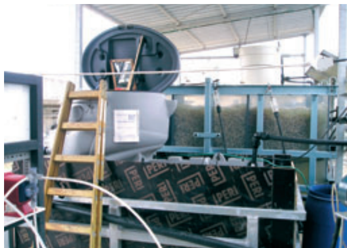
Obr. 4: Využití technologie firmy Aqwise v malých (domovních) čistírnách splaškových vod, proces řízen zabudovaným PC
