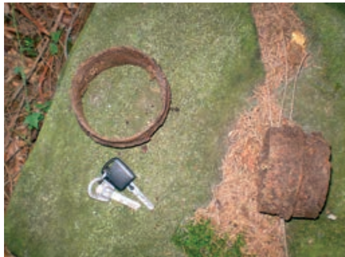
Obr. 3: Ocelové zděře pro spojování dřevěného vrtaného potrubí, nalezené poblíž Tachova. Tyto zděře byly součástí dřevěného potrubí přivádějícího vodu do Pavlánského kláštera
