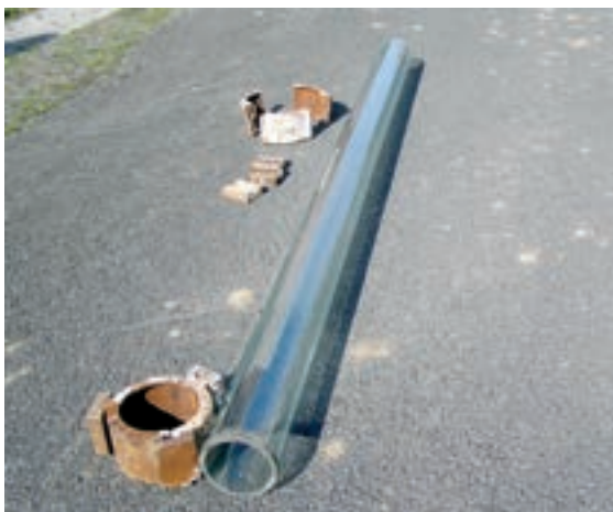
Obr. 9: Skleněné potrubí a Vymerovy spojky (bez těsnění)
