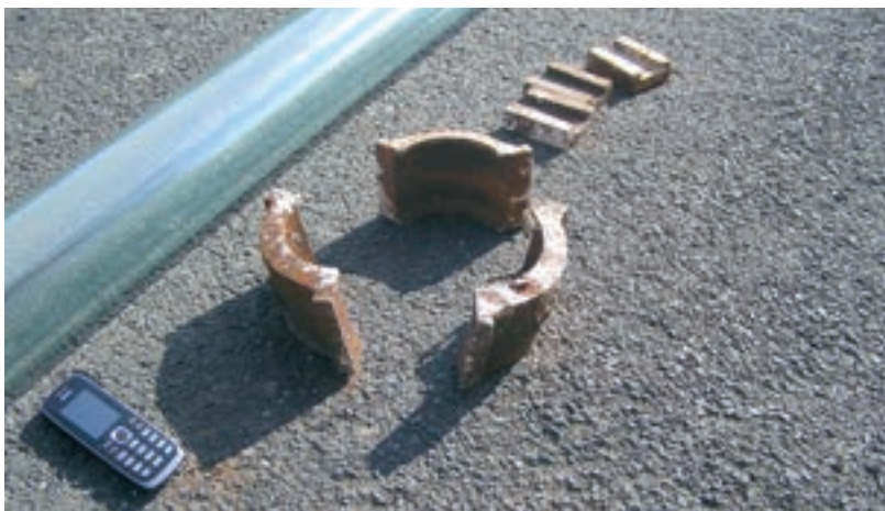
Obr. 10: Vymerova spojka pro skleněná potrubí (bez těsnění)
