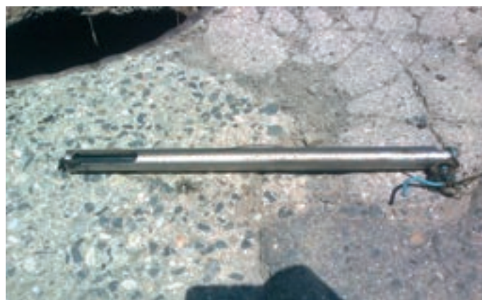
Obr. 8: Záznamník dat se zachycenými nečistotami
