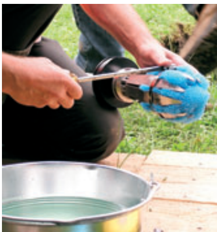
Obr. 3: Balónek vložený do zaváděcího přípravku před dezinfekcí ve vědru s dezinfekčním roztokem
