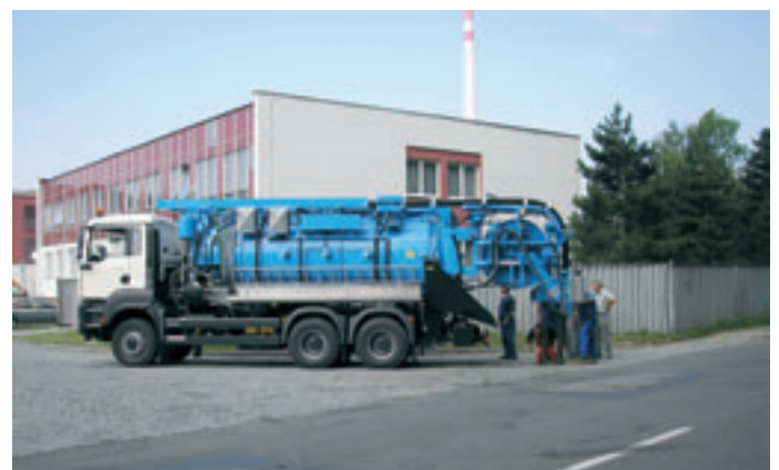
Kanalizační vůz Hellmers v akci
