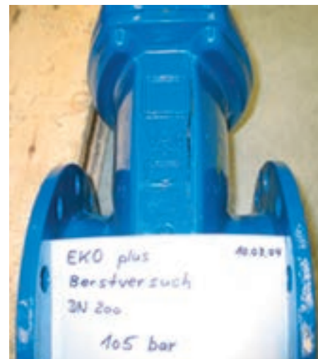
Obr.: Porušení integrity měkkotěsnicího šoupátka DN 200 PN 10. Testovací tlak 105 barů přesáhl 4x maximální zkušební tlak 24 barů pro zkoušení vodárenských armatur zkouškou pevnost a nepropustnosti.
