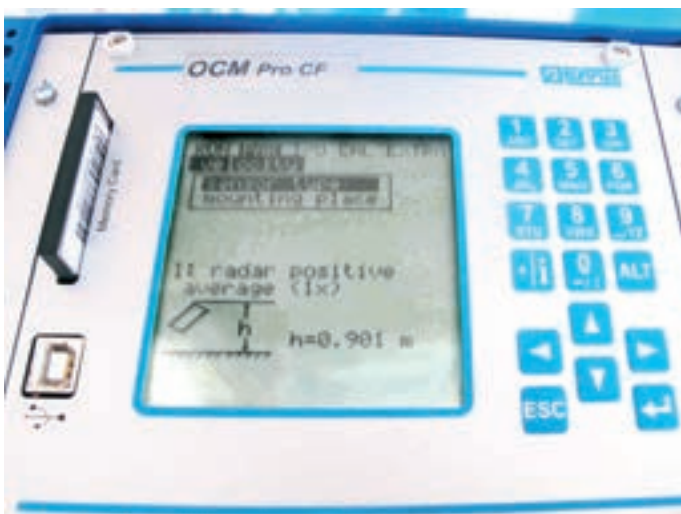
Obr. 2: Nastavení montážní výšky OFR senzoru
