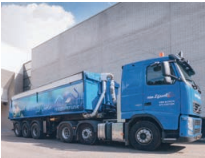
Nákladní vozidlo pro převoz pelet, na kterém se tvrdé zrno vysušuje odpadním teplem motoru
