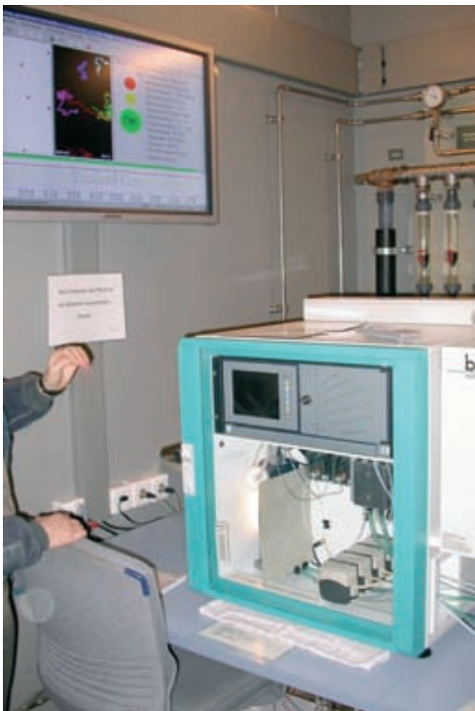
Obr. 6: On-line biomonitoring na vodárně v curyšském Hardhofu, využívací dafnie. Dole „reaktor“ s dafniemi, vlevo nahoře na stěně obrazovka, na kterou se přenáší snímání a vyhodnocovaný pohyb dafnií. Software spustí automatický alarm při překročení varovné meze
