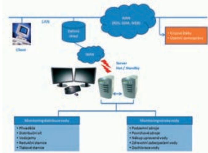
Obr. 3: Typické komunikační schéma centrálního dispečinku
